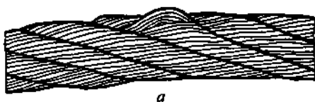
Рисунок 19 – Выдавливание проволок прядей: а — в одной пряди; б — в нескольких прядях
